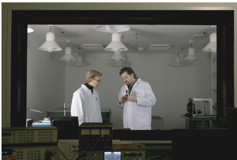
Kuva 1. Mikrofonien resiprookkikalibrointi alkamassa äänieristetyssä laboratoriossa.
