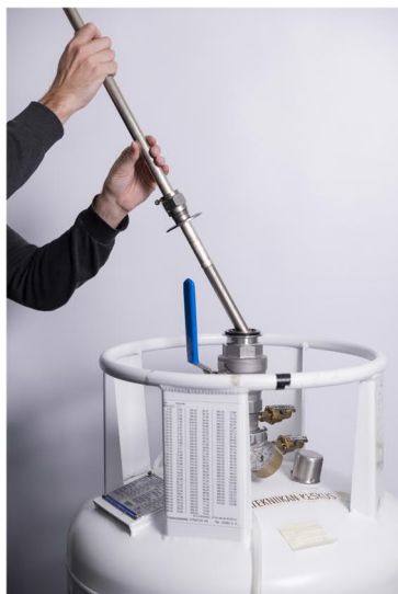
Kuva 1. Tasajännitteen jäljitettävyyden perustuu nesteheliumissa jäähdytettävään Josephson-normaaliiin.
