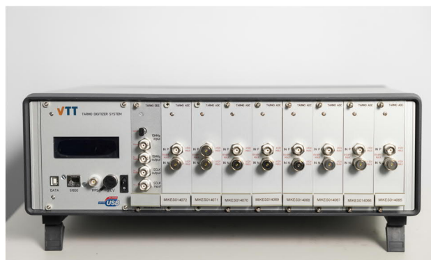
Kuva 1. Kuusikanavainen mittanormaali tehokalibrointeihin. Tämän avulla voidaan kalibroida myös tehon harmonisia ja IEC 61850-9-2 LE ja IEC 61869-9 mukaisia digitaalisia mit- talaitteita.
