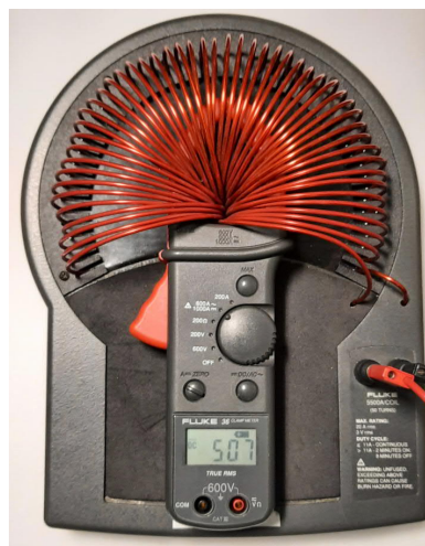
Kuva 2. Pihtivirtamittari 50 kierroksen kalibrointikelassa mittaa suurta 500 A tasavirtaa.
